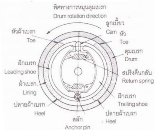
กลไกระบบดรัมเบรก Mechanical drum brake system
