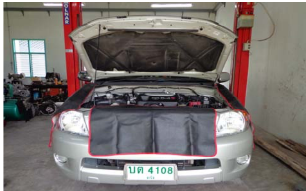
ภาพที่ 16 แสดงการติดตั้งผ้าคลุมรถ
